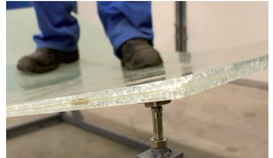
Ensayo de fatiga, proceso de control del vidrio
